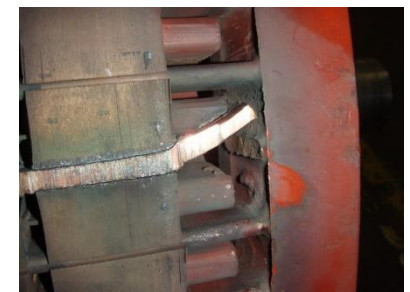
Figura 7 Rotor con una barra rota (Fuente: www.hecoinc.com)
