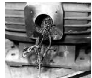
Figura. 4 Motor con falla producto de un problema en la conexión (Fuente: EASA)
