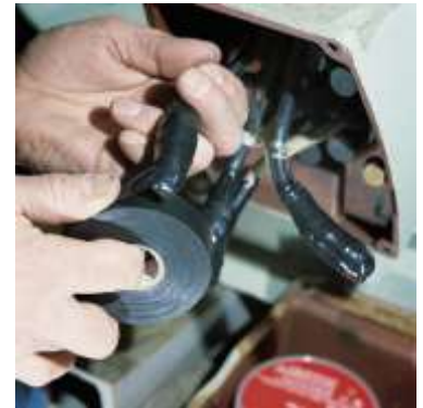
Figura. 5 Acabado final del método recomendado en la Tabla I para motor de BT
