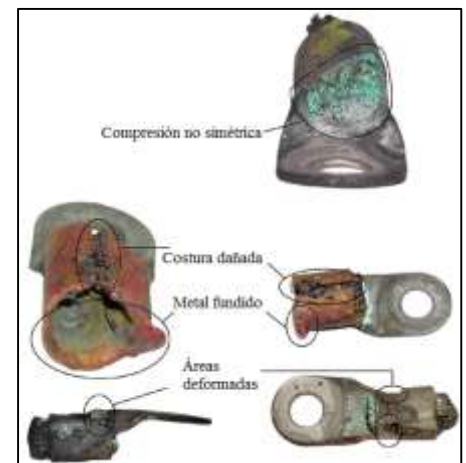
Figura. 7 Daños en terminales de motores de BT (Fuente: EASA)
