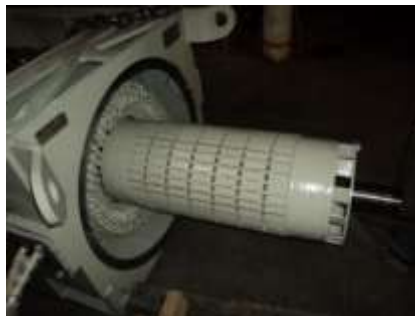
Figura 5 Motor eléctrico de 1025HP balanceado dinámicamente
