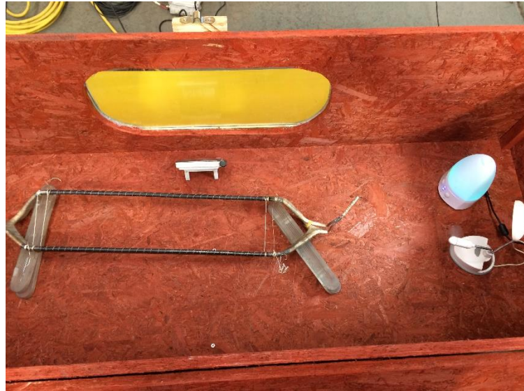
Figura 3 Montaje experimental para comprobar relación de las DPs con la humedad relativa
