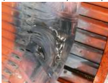
Figura 1 Algunas fallas en devanados (Cortesía de Ferroman S.A.)
