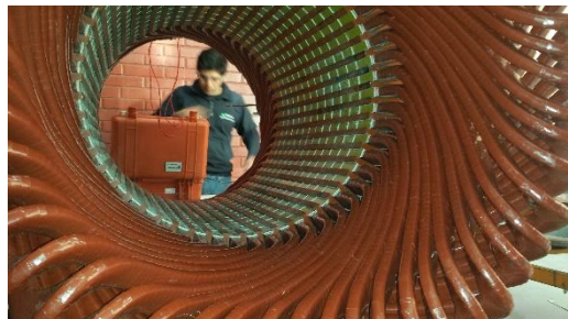
Figura 5 Vista del devanado completo durante ensayos dieléctricos
