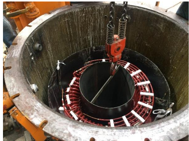
Figura 5 Inicio del proceso de impregnación por VPI
