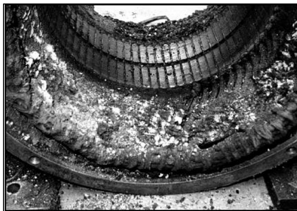
Mal Proceso de Construcción dejó Vacíos en el Bobinado
