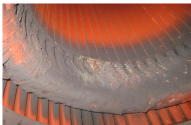
Falla en el encintado del rotor bobinado
